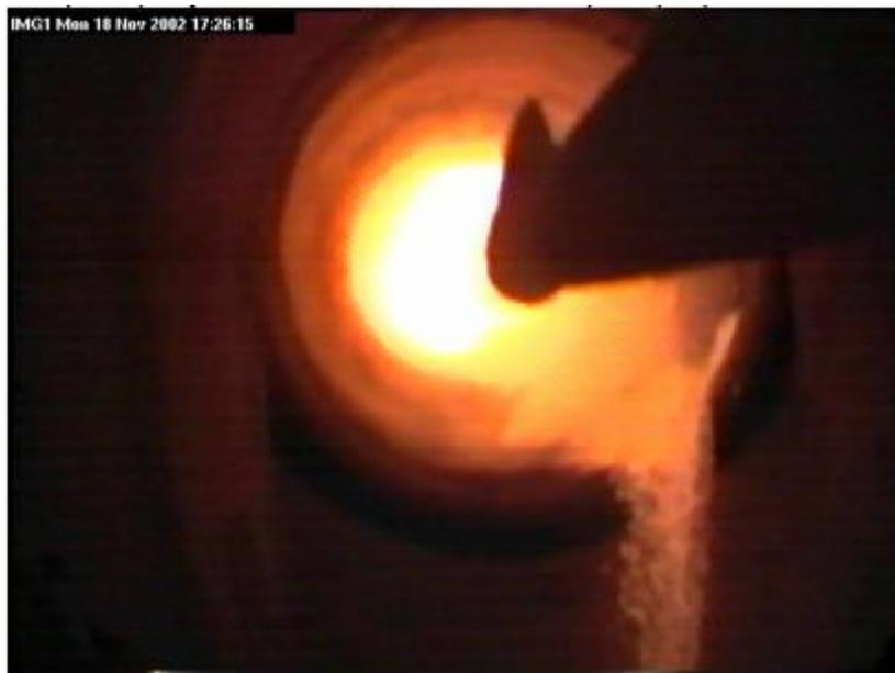
Изображение в реальном времени на цветном видео мониторе: Огонь факела, слой клинкера и головка печи
